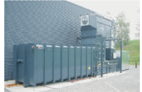
In der stationären Containerpresse CP-6000 wird das bereits zerschnittene Material unter hohem Druck gepresst
